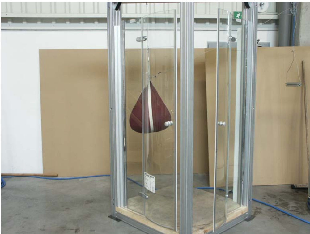
Náraz z vnitřní strany – průběh zkoušky
