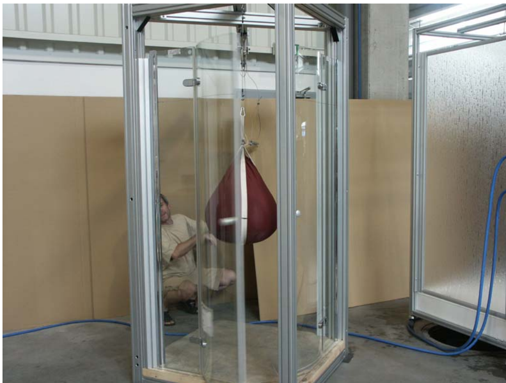
Náraz z vnitřní strany – průběh zkoušky
