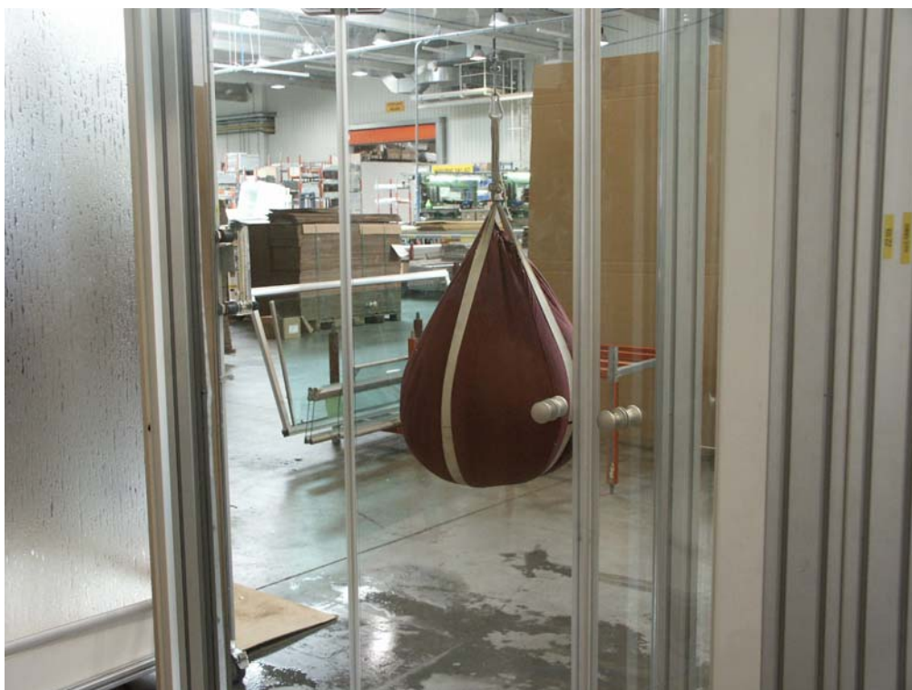
Náraz z vnější strany – průběh zkoušky.
