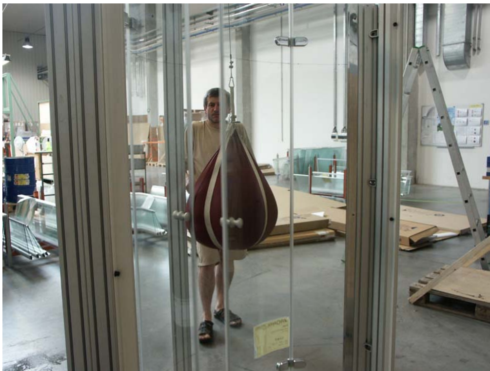
Náraz z vnější strany: průběh zkoušky.
