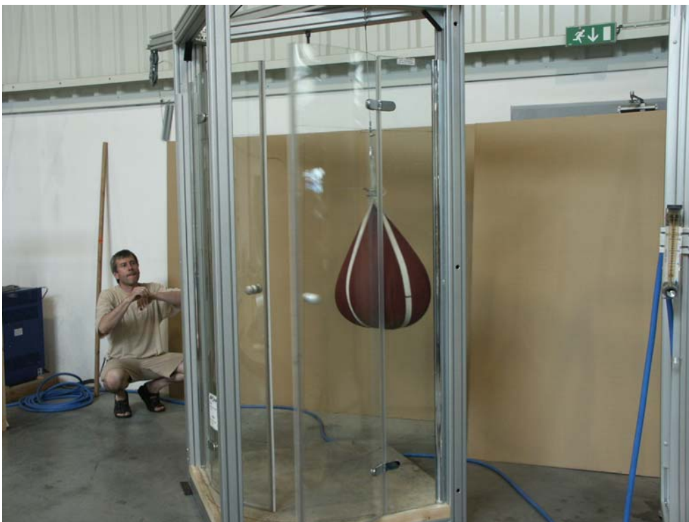
Náraz z vnitřní strany – průběh zkoušky
