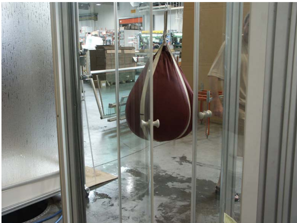
Náraz z vnější strany – stav po zkoušce: bez závad.
