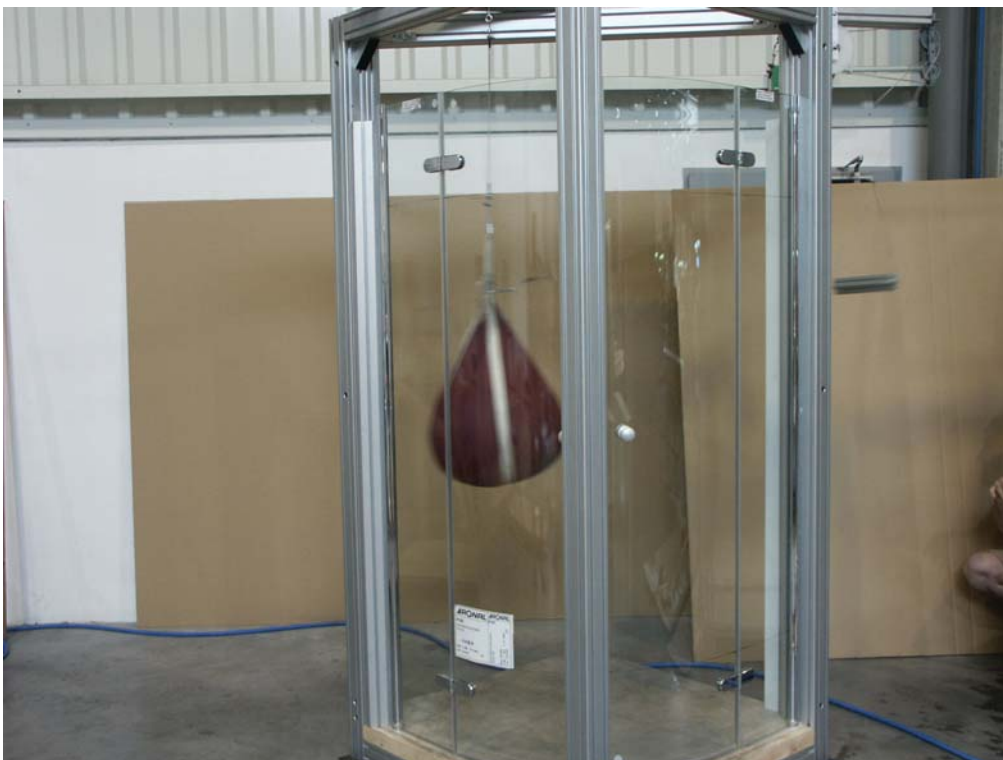
Náraz z vnitřní strany – průběh zkoušky
