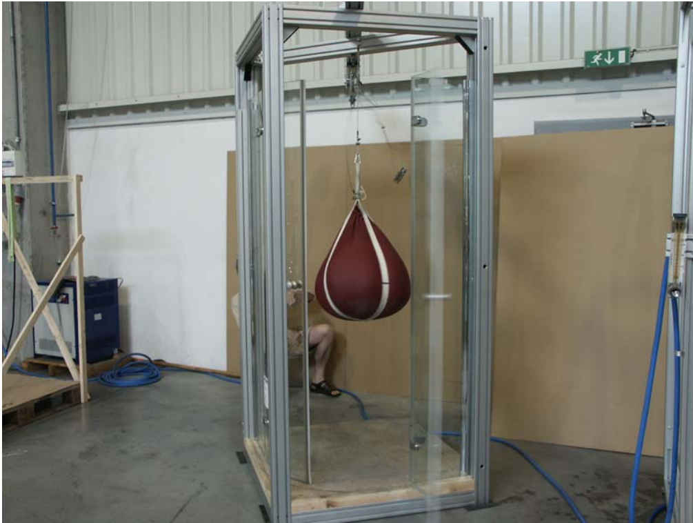
Náraz z vnitřní strany – průběh zkoušky
