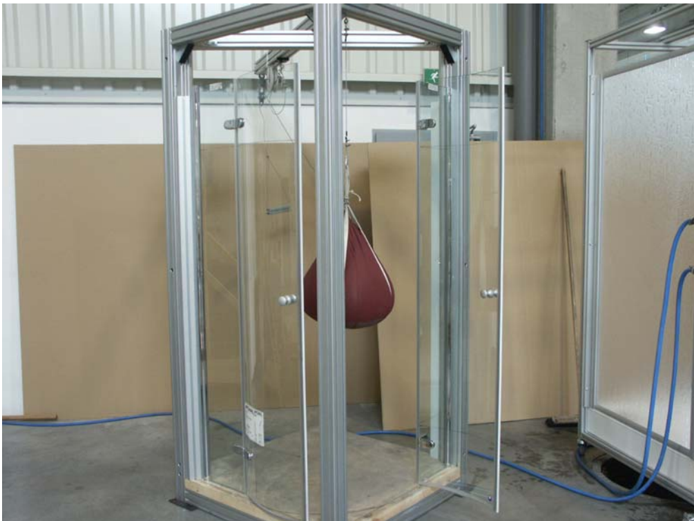
Náraz z vnitřní strany – stav po zkoušce: bez závad
