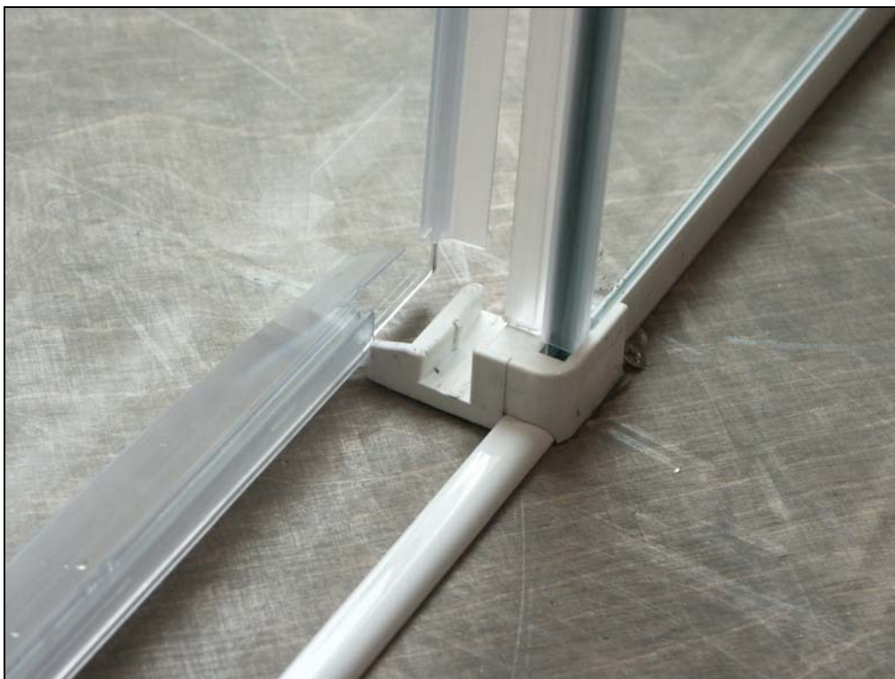
Náraz z vnější strany, posuvný díl – stav po zkoušce: posuvné sklo vyraženo z vodicího dílu (po vyjmutí vodicího dílu možno nasadit zpět – postup jako při čištění).
