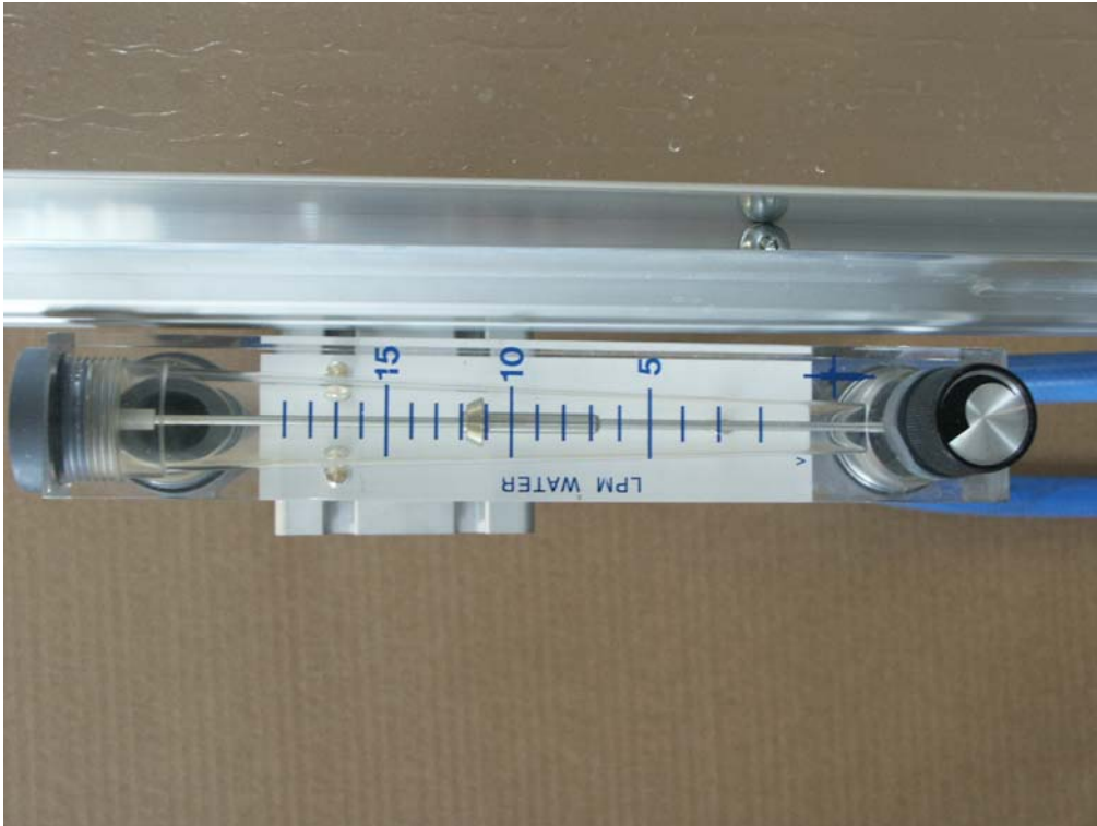
Měření průtoku vody do zkušební sprchové růžice.
